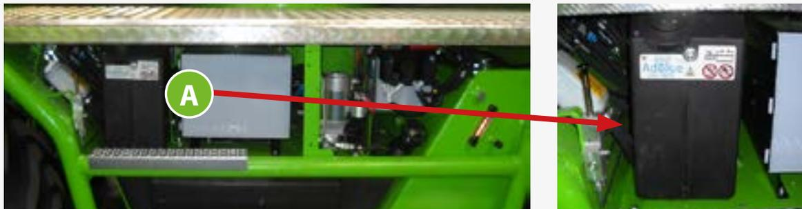
Der Harnstofftank (A) fasst 25 Liter, die für zwei Dieseltankfüllungen ausreichend sind. Eine Kontrollleuchte auf dem Armaturenbrett weist darauf hin, wenn aufgetankt werden muss.
