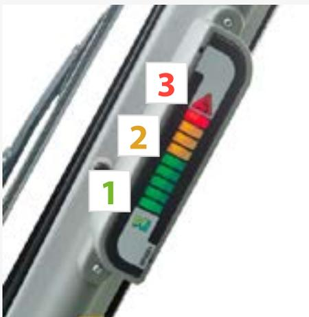
Der Stabilitätszustand der Maschine wird ständig über die Leuchtanzeige (25) in der Kabine angezeigt, die über 3 Informationsabschnitte verfügt.
