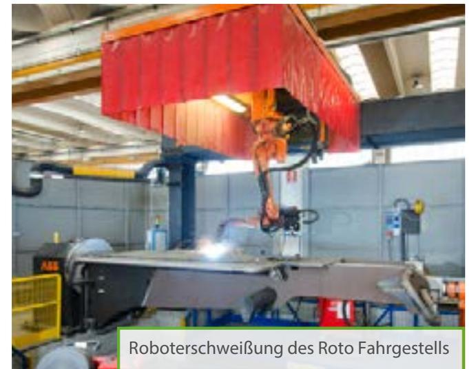
Roboterschweißung des Roto Fahrgestells
