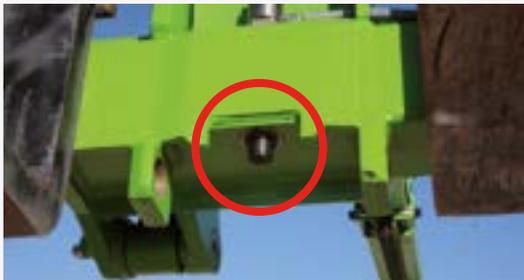
Das Tac-Lock-System erlaubt die hydraulische Befestigung der Anbaugeräte direkt von der Kabine aus und macht den Anbaugerätewechsel einfach und sicher.
