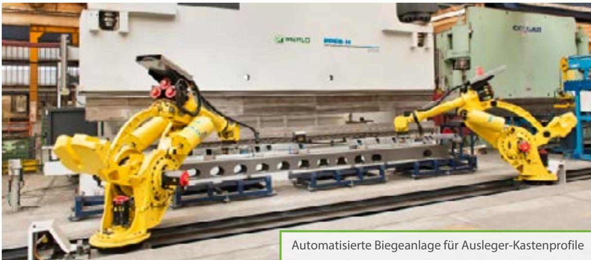
Automatisierte Biegeanlage für Ausleger-Kastenprofile
