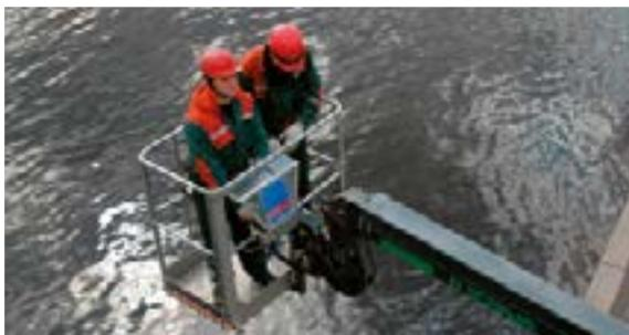
Unabhängig vom eingesetzten Bühnentyp steuert der Bediener alle Bewegungen von der Hubarbeitsbühne aus.
