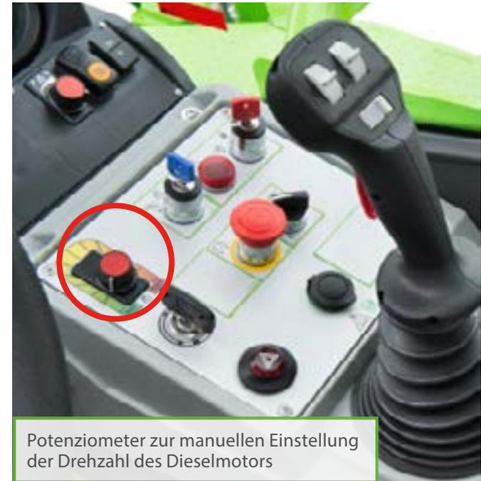
Potenziometer zur manuellen Einstellung der Drehzahl des Dieselmotors
