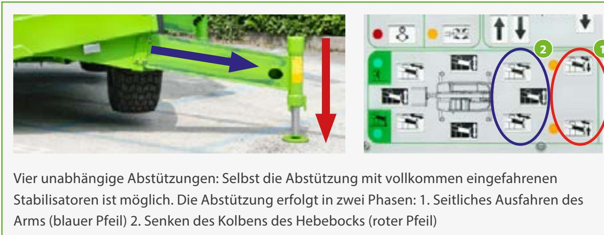
Vier unabhängige Abstützungen: Selbst die Abstützung mit vollkommen eingefahrenen Stabilisatoren ist möglich. Die Abstützung erfolgt in zwei Phasen: 1. Seitliches Ausfahren des Arms (blauer Pfeil) 2. Senken des Kolbens des Hebebocks (roter Pfeil)
