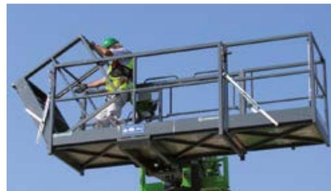
Bei einigen Hebebühnen von Merlo ist die Nutzbreite veränderlich über ein praktisches und patentiertes Erweiterungssystem, das auch in der Höhe betätigt werden kann.
