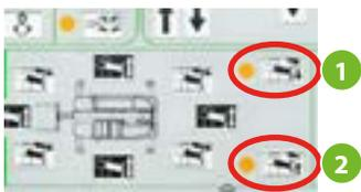
Wird die Taste 1 drei Sekunden lang gehalten, setzt sich der Mechanismus der **automatischen Abstützung** in Gang. Taste 2 betätigt das automatische Einziehen.
